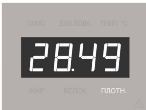
Рисунок 2.9 - Плотность молока 28,49 в градусах ареометра (1028,49 кг/м<sup>3</sup>)
