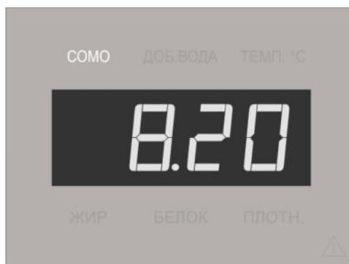
Рисунок 2.13 – Настройка порога СОМО, контрольное значение СОМО 8,20
