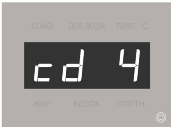
Загорание желтого сигнального индикатора предупреждает пользователя, что измеряемая проба по некоторым показателям отличается от таковых для сырого цельного молока. Для просмотра этих отличий следует в режиме индикации нажать и удерживать кнопку «Номер градуировки», при этом на индикаторе прибора появится код, соответствующий определенному критерию срабатывания индикатора.
